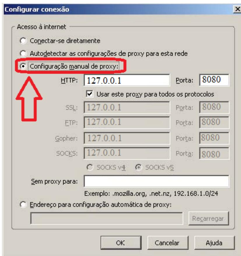
Figura 7 - Habilite a caixa de “Configuração manual de Proxy”
